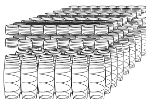
どんぐり型ポケットコイル：【並列】 + 薄型インナーポケットコイル：【千鳥】 + 薄型インナーポケットコイル：【並列】
